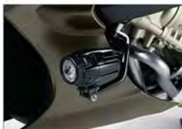
Projecteurs additionnels à LED
