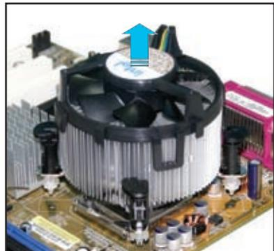
5. Tournez chaque mécanisme de serrage dans le sens des aiguilles d'une montre pour avoir une bonne orientation lors d'une ré-installation.
