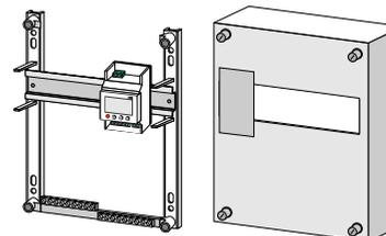
**T3S digit** est monté sur rail DIN en armoire électrique
