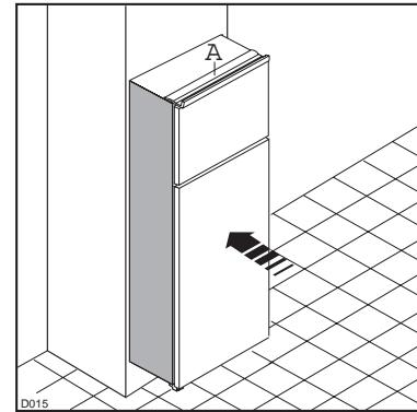
Appliquer en appuyant le dispositif de masquage du joint, entre l'appareil et le meuble.
