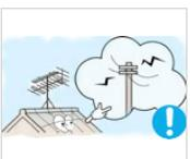
▶ Installez l'antenne loin de tout câble à haute tension.
