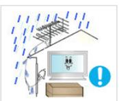
▶ Pliez le câble d'antenne extérieure vers le bas à l'endroit où il rentre, de manière à éviter toute infiltration d'eau de pluie.
