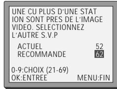
Si les autres stations sont placées près de courant programme sortie de RF "RF OUTPUT PR", le message de guide apparaît automatiquement.
