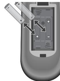
Insérez les piles dans le compartiment comme indiqué sur le schéma.
