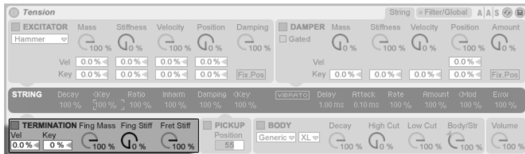
Section Termination du Tension.
