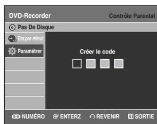
**4** Créez un mot de passe à 4 chiffres en utilisant les touches numériques 0 à 9 sur la télécommande.
