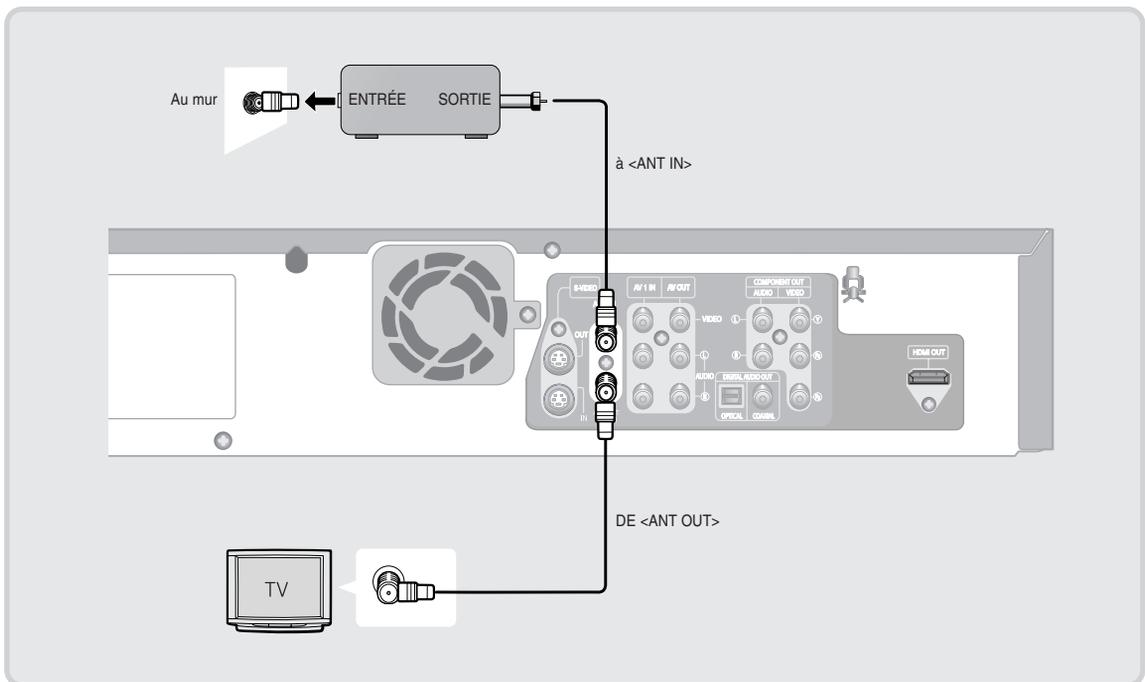
**Antenne + Graveur DVD avec Magnétoscope + Câblodélecteur + Téléviseur : Câblodélecteur à quelques chaînes brouillées.**
