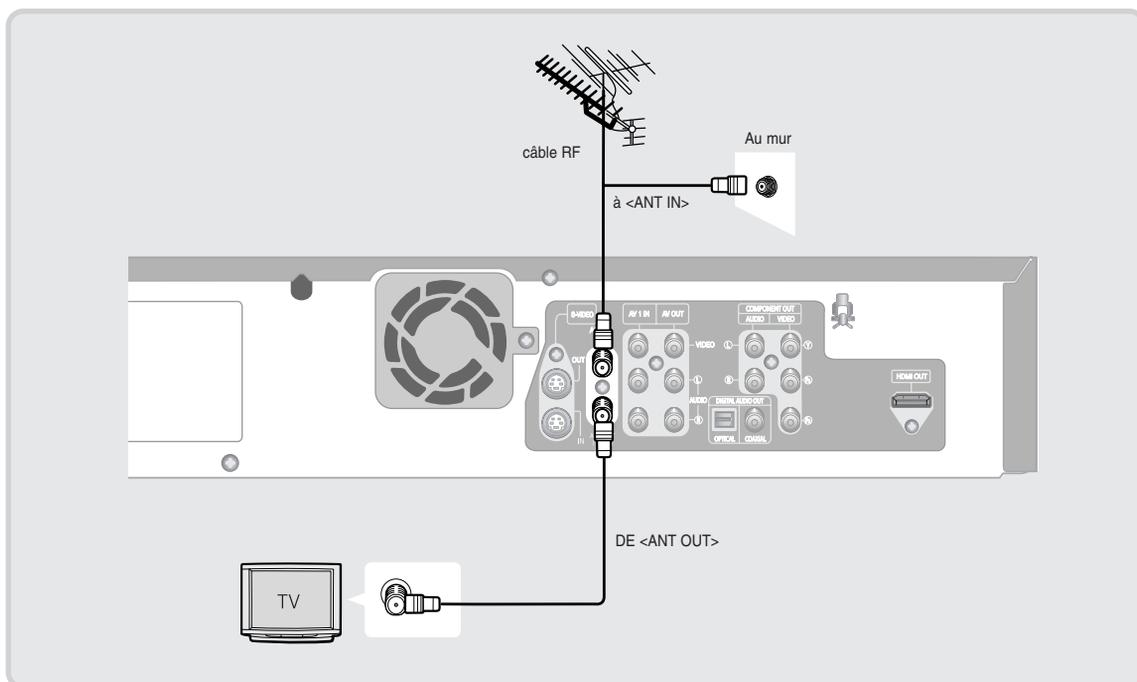
**Remarque** ■ Si vous utilisez une antenne extérieure avec un câble plat de 300 ohm, utilisez un adaptateur externe (300 à 75 ohm : non fourni) pour raccorder l'antenne au graveur DVD avec magnétoscope.
