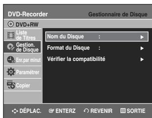
**3** Sélectionnez **Vérifier la compatibilité** en déplaçant la barre de sélection à l'aide des touches ▲▼, puis appuyez sur **ENTER** ou sur ▶.
