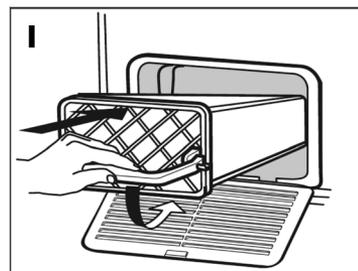
**J.** Réinstallez le volet du filtre de socle.
