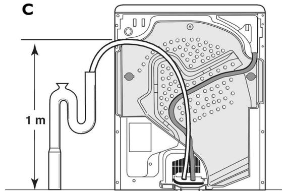
**Avertissement :** pour éviter l'effet de siphon, l'extrémité du tuyau ne doit pas être immergée dans l'eau de vidange. Évitez de plier et de tordre le tuyau.
