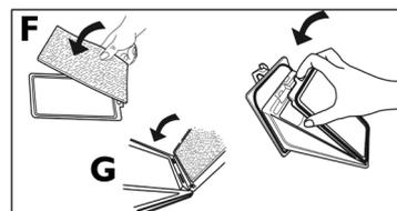
**G.** Installez le cadre du filtre dans le logement en introduisant les languettes du cadre dans les fentes situées sur le cadre du filtre et en bloquant le cliquet d'arrêt. Vérifiez que la mousse n'est pas coincée entre les éléments du filtre.
