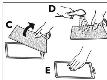
**E.** Éliminez à la main les peluches présentes sur les deux éléments du filtre. Si le filtre est recouvert d'une substance blanche et que vous ne parvenez pas à éliminer celle-ci à la main, passez les éléments du filtre sous l'eau courante. Au besoin, utilisez une brosse douce.
