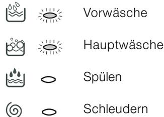
Anmerkung: Während des Abpumpens leuchtet die entsprechende Kontrollleuchte für die Schleuder auf.
