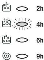
Nach und nach wird die bis zum effektiven Start noch verbleibende Zeit eingeblendet, die entsprechende Kontrollleuchte blinkt:
