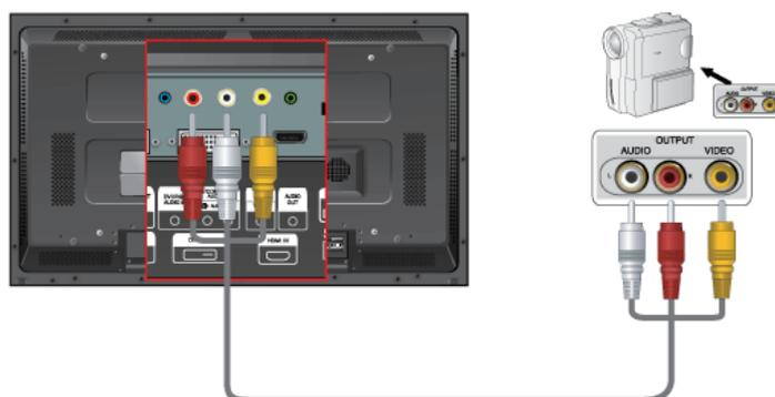
1. Localisez les jacks de sortie AV sur le caméscope. Généralement, ils se situent sur le côté ou au dos du caméscope. Au moyen d'un jeu de câbles audio, reliez les prises AUDIO OUTPUT du caméscope et AV/COMPONENT AUDIO IN [R-AUDIO-L] de l'écran LCD.
