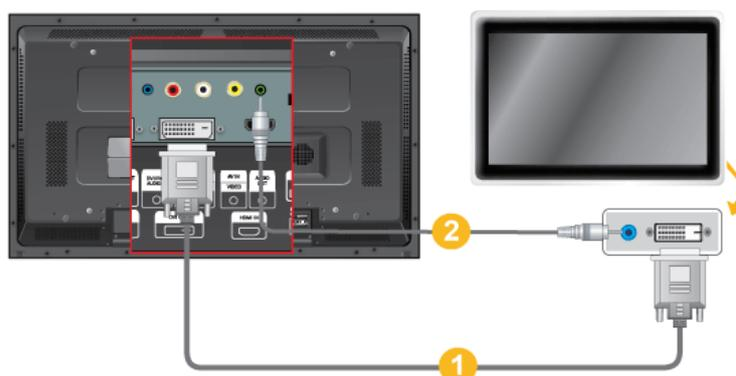
1. Effectuez une connexion entre le port DVI OUT du moniteur LCD et le port d'entrée d'un autre moniteur à l'aide d'un câble DVI.
