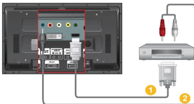
1. Connectez la borne de sortie DVI d'un périphérique de sortie numérique à la borne HDMI IN du moniteur à l'aide d'un câble DVI vers HDMI.
