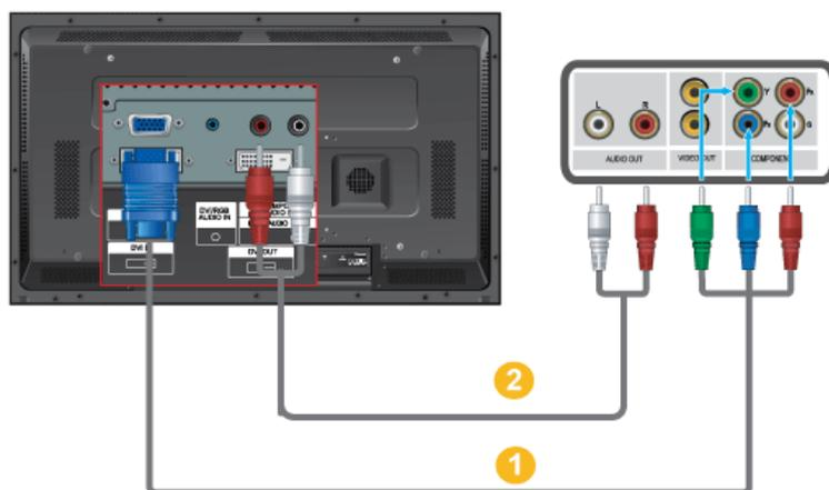
1. Connectez le câble Component vers D-sub (vendu séparément) au port RGB/COMPONENT IN de l'appareil et aux ports COMPONENT - PR, Y et PB du décodeur STB.
