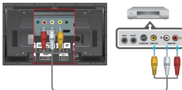
1. Raccordez les ports Vidéo et Audio [R-AUDIO-L] du lecteur DVD, du magnétoscope ou du décodeur DTV aux ports Vidéo et Audio [R-AUDIO-L] de l'écran LCD.
